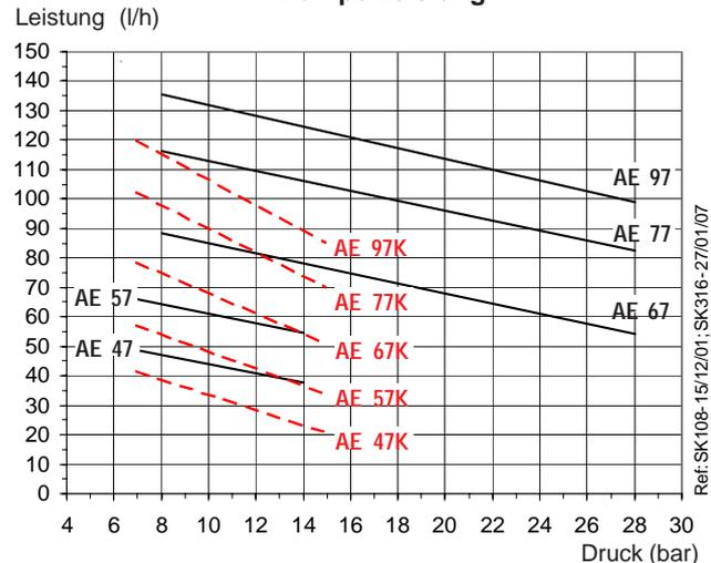
In den dargestellten Kurven ist bereits eine Abnutzung des Getriebes berücksichtigt. Achten Sie deshalb darauf, daß Sie bei der Wahl der Getriebekapazität, die Pumpe nicht überdimensionieren.
