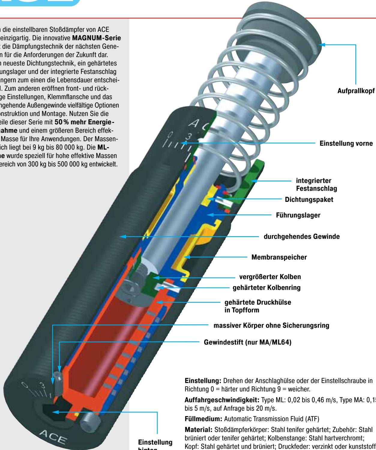
**Einstellung:** Drehen der Anschlaghülse oder der Einstellschraube in Richtung 0 = härter und Richtung 9 = weicher.
