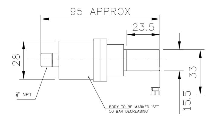
PRESSURE SWITCH C/W ELECTRICAL CONNECTOR;
