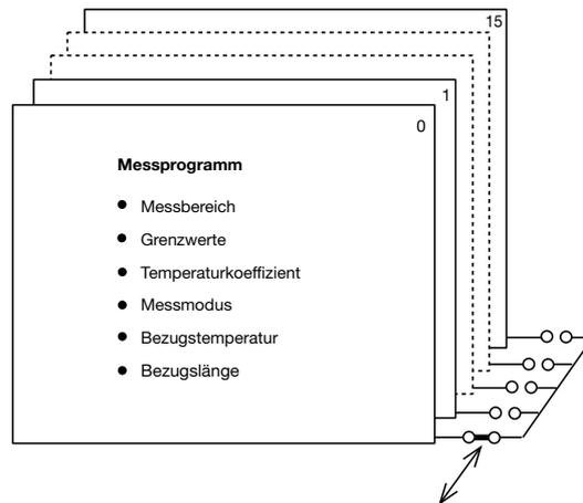
Für schnelle Prüflingswechsel können im RESISTOMAT® 2316 16 Messprogramme hinterlegt und per SPS, Hand oder RS232 (USB, Ethernet) umgeschaltet werden.
