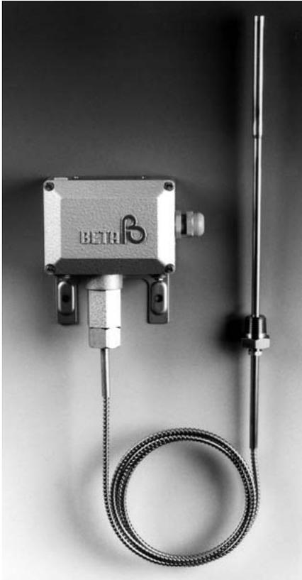
Der BETA-Temperaturschalter basiert auf dem bewährten Druckschalter mit integriertem 2-Phasen- (Gas/flüssig) Temperatursensor. Beim Anstieg der Prozesstemperatur steigt der Dampfdruck der Flüssigkeit. Beim Überschreiten des eingestellten Ansprechdruckes wird der Mikroschalter betätigt.
