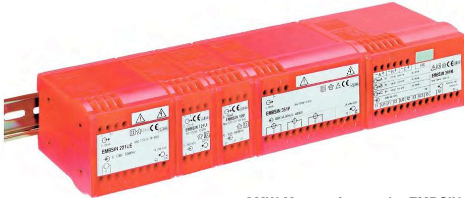
**GMW-Messumformer der EMBSIN-Baureihe setzen eine Eingangswchselspannung und/oder einen Eingangswchselstrom, welche als Standardsignal von einem Strom- oder Spannungswandler oder direkt aus dem Starkstromnetz kommen, in einen eingepprägten Ausgangsstrom oder eine aufgeprägte Ausgangsspannung um.**
