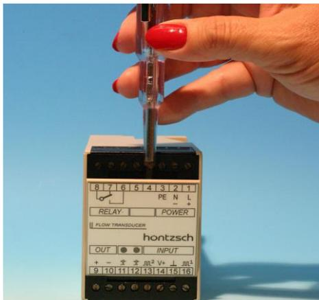
Abb 1: Frontabdeckung mit Schraubendreher entfernen
