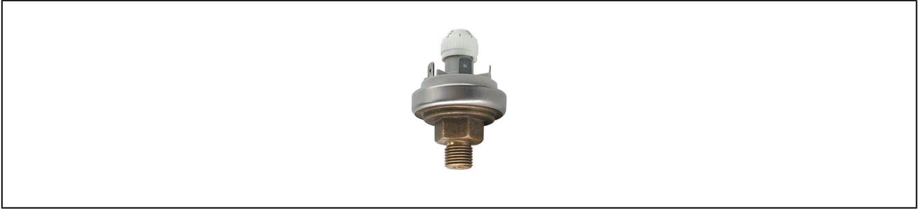
Beschreibung Vakuumschalter Serie 901.7 Wechselkontakt; Membrane NBR; Einstellskala; 250VAC/6A; 24VDC/2A; Außengewinde 1/4"; Anwendung: Luft, Wasser, neutrale Öle; Schutzart siehe Schutzkappe (max. IP65)
