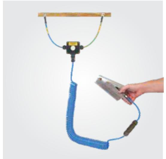
**Bond-Rite ERDUNGSKLAMMER:** mit zweiadrigem Kabel, Anschlusskasten, Verstaungszapfen für die Erdungsklammer und Erdungsleitungen. Die Platte zur Überwachung des Stromkreises sowie die Batterie befinden sich im Innern der Erdungsklammer. Die Erdungssammelschiene ist nicht im Lieferumfang enthalten.
