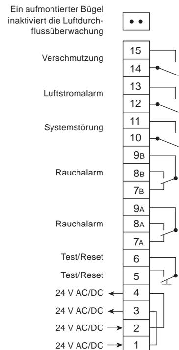
Die Relaisausgänge werden im ausgeschalteten/Alarm-Modus angezeigt.
