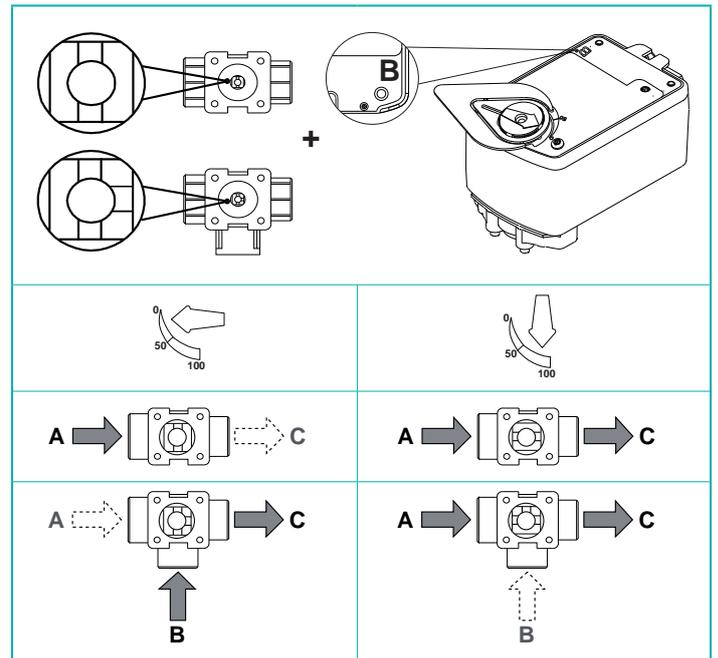
Figure 7 : Normalement Fermé (le ressort ferme la vanne)
