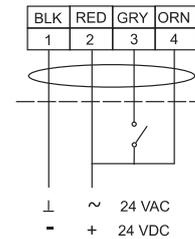
Commande 3 points (Flottant), Raccordement parallèle
