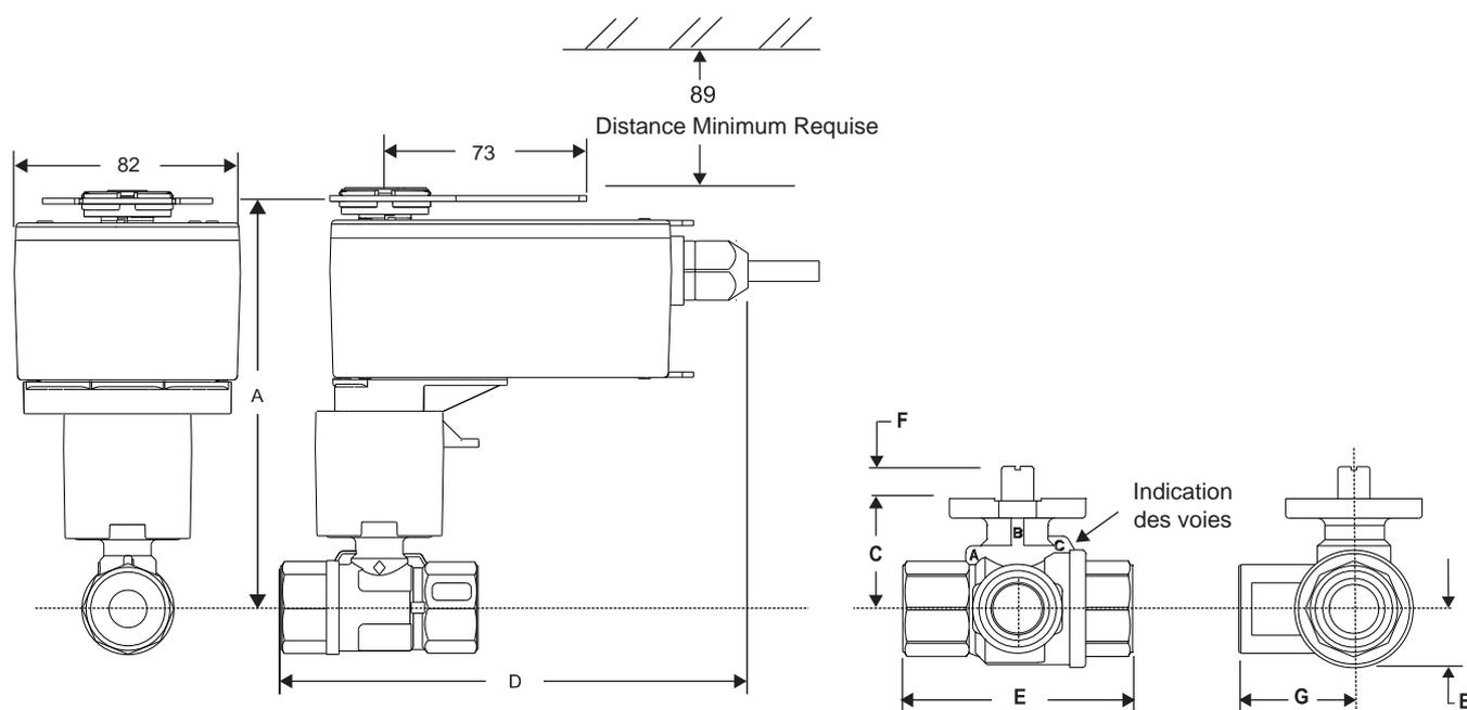
Figure 9 : Servomoteurs avec ressort de rappel BxFx.03(S)(Z), vannes à boisseau JV205 et JV305 et barrière thermique
