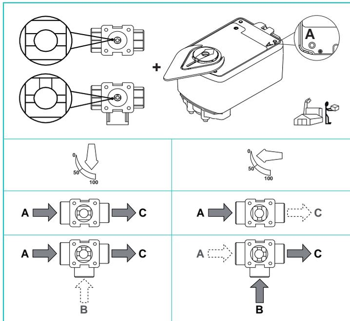
Figure 6 : Normalement Ouvert (le ressort ouvre la vanne)
