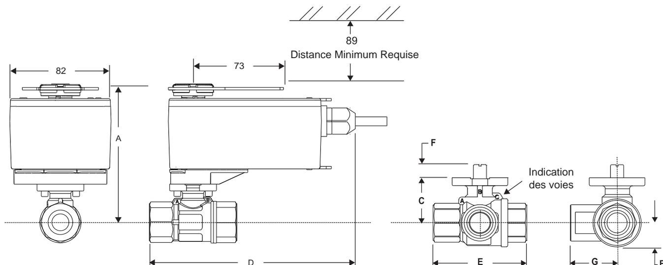
Figure 8 : Servomoteurs avec ressort de rappel BxFx.03(S)(Z) et vannes à boisseau sphérique JV205 et JV305
