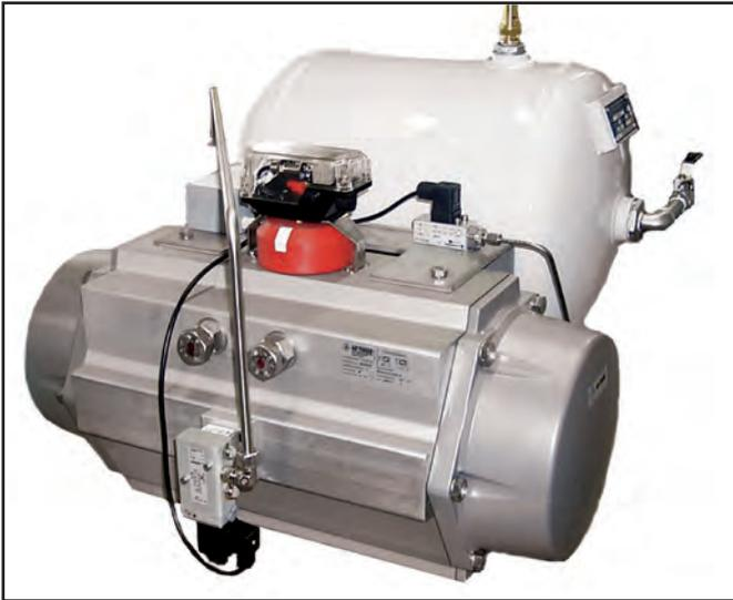
Luftbehälter dienen als Energiespeicher. Sie werden eingesetzt um bei Energieausfall mindestens eine automatische oder manuelle Schaltung zu ermöglichen. In bestimmten Applikationen wird die Sicherheit hierbei höher eingestuft, da kein Federbruch erfolgen kann.
