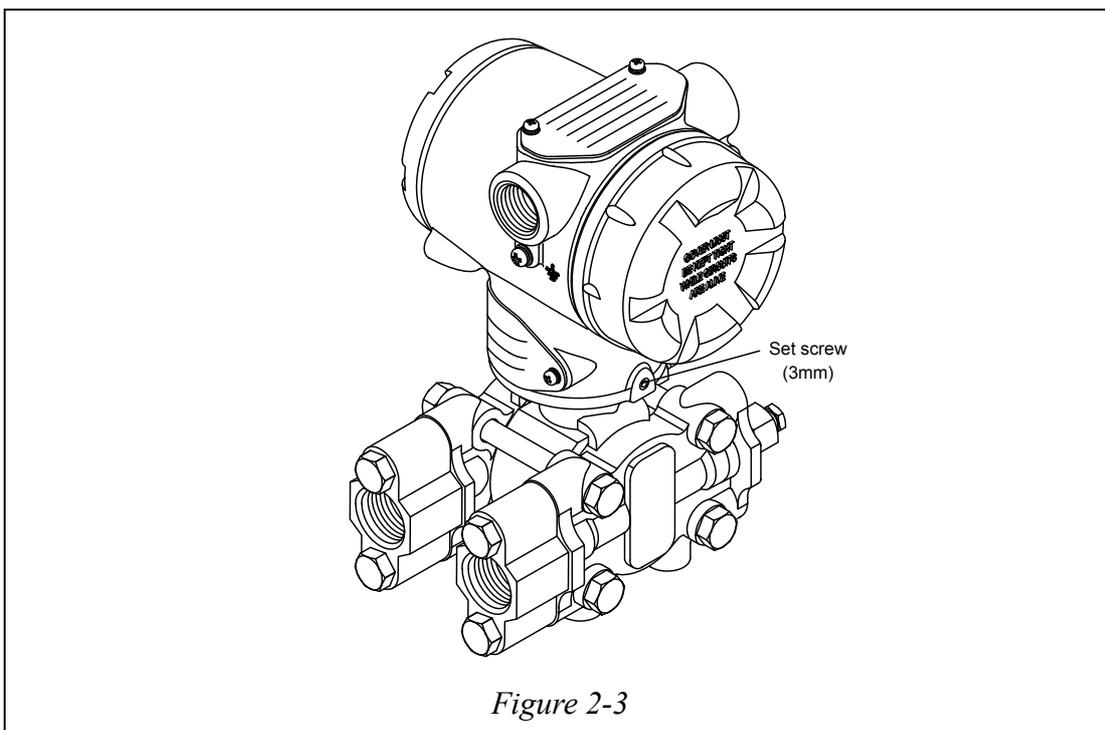
**b) Rotate digital display module**
