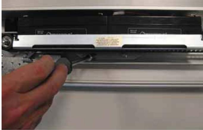
Die Akkus mit den mitgelieferten Kabeln wie auf der Abbildung dargestellt an die Steuerung [2] anschließen.
