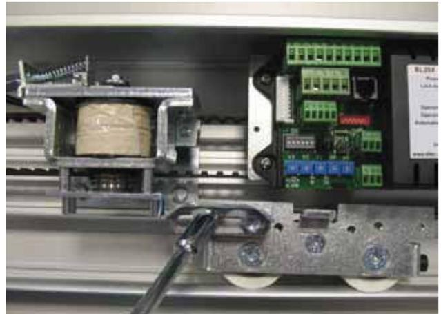
Die Verriegelung mit den mitgelieferten Kabeln wie auf den Abbildungen dargestellt an die Steuerung [2] anschließen.
