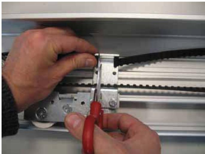
Den Zahnriemen wie auf der Abbildung dargestellt in den Befestigungsbügel des Zahnriemen [8] einsetzen, und den Riemen mittels die Klemmungsbügel des Zahnriemen blockieren.
