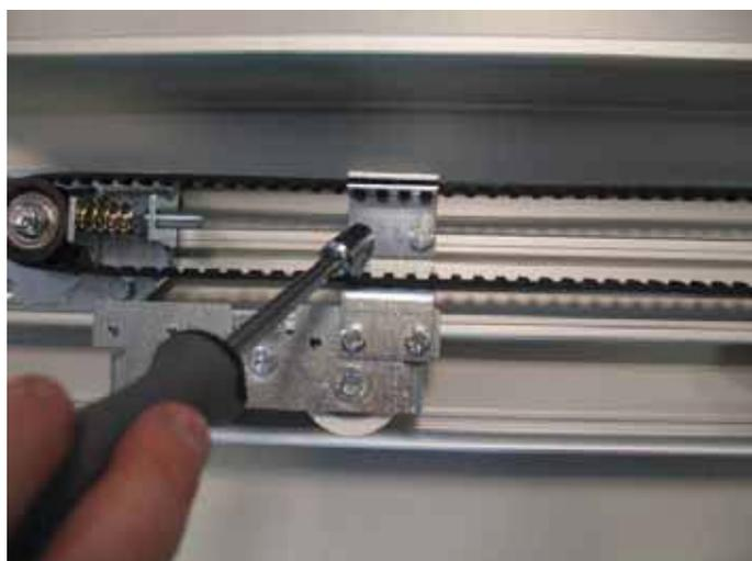
Die Befestigungsschrauben der Umlenkrolle [4] lockern, und den Zahnriemen von Hand nach links verschieben. Die Umlenkrolle fixieren, indem man deren Befestigungsschrauben anzieht.
