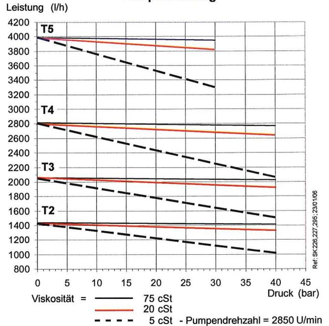
Die in den Kurven angegebenen Werte gelten für neue Pumpen (ohne Abnutzungserscheinungen).
