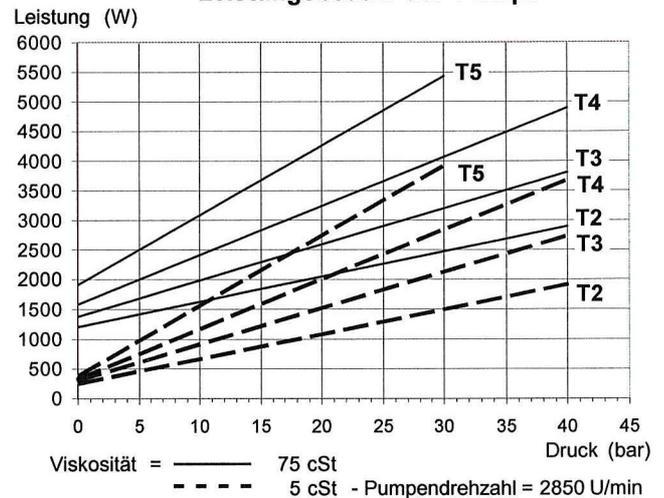
Die in den Kurven angegebenen Werte gelten für neue Pumpen (ohne Abnutzungserscheinungen).
