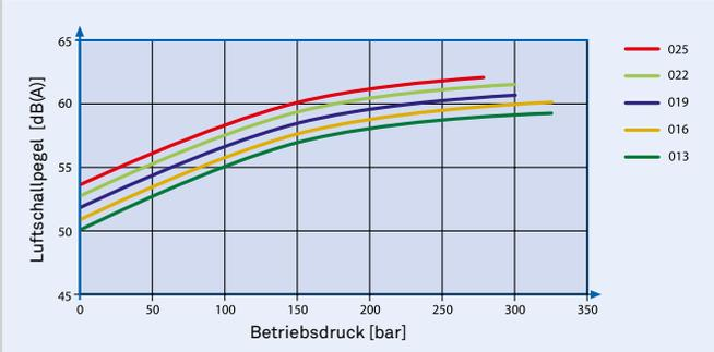
Messbedingungen: Drehzahl 1450 min<sup>-1</sup>, Viskosität 46 mm<sup>2</sup>/sek., Betriebstemperatur 40 °C
