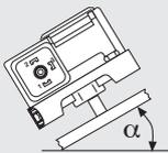
**Bei Einbau in einer Zwischeneinbaulage schaltet der Druckwächter bei einem vom eingestellten Sollwert maximal höheren bzw. niedrigeren Druck.**
