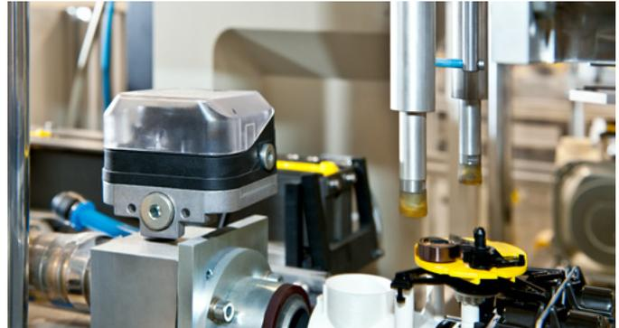
Durch die Überwachung des Unterdrucks ist die richtige Position der Bauteile bei der vollautomatischen Montage von Gaszählern sichergestellt.
