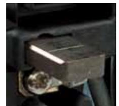
*Die Gleitschuhe können mittels Schwalbenschwanzverbindungen schnell und einfach angebracht werden. Eine optische Inspektion wird durch die angebrachte Kennzeichnung ermöglicht.*
