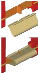
Montage der Verbindungsklemme Cu-C
