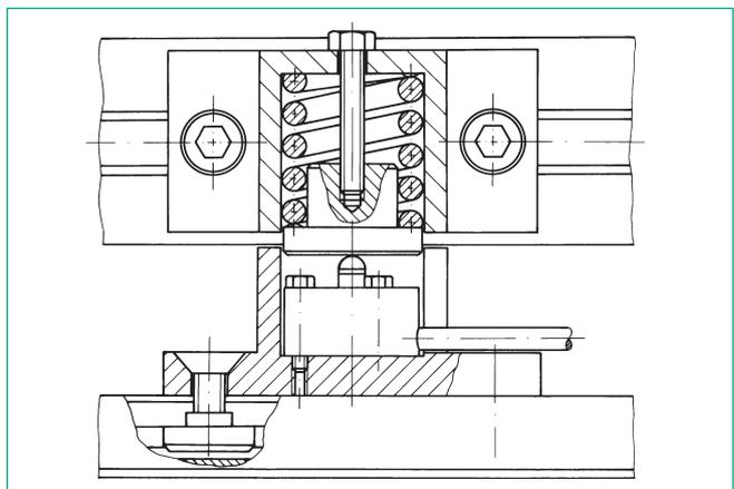
Eine Überlastung des Sensors wird durch eine geeignete Feder verhindert. Wenn die Bauteile aufsitzen, darf sie nur so viel Kraft an den Sensor übertragen, dass dessen Messbereich dafür ausreicht.
