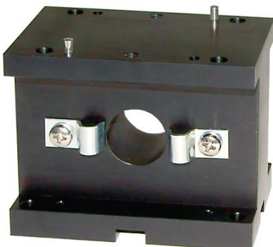
Mittels Stiftpassung kann der Sensor im Bedarfsfall schnell getauscht werden, ohne ihn erneut aufwändig ausrichten zu müssen. Dies kann hilfreich sein, wenn der Sensor nur sporadisch im Laststrang eingesetzt wird. Der Lagerbock ermöglicht durch seine zentrische Bohrung und seine spezielle Konstruktion unterschiedliche Varianten zur sicheren Kabelverlegung. Zwei Schellen sorgen für eine optimale Befestigung.
