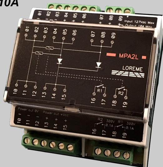
Le module de redondance permet de fournir une protection efficace contre les défaillances d'alimentations. Grâce au découplage de deux alimentations, la défaillance de l'une d'elle reste sans impact sur la sortie, l'autre prenant automatiquement sa fonction sans interruption de service.
