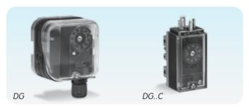
Gas-Druckwächter DG, DG..C zur Überwachung des Druckes zwischen den zu prüfenden Ventilen.
