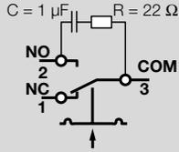
Beim Einsatz von Silikonschläuchen ausreichend getemperte Silikonschläuche verwenden. Silikonhaltige Dämpfe können die Kontaktgabe stören. Bei kleinen Schaltleistungen, wie z. B. bei 24 V, 8 mA, in silikon- oder ölhaltiger Luft wird der Einsatz eines RC-Gliedes (22 Ω, 1 μF) empfohlen.
