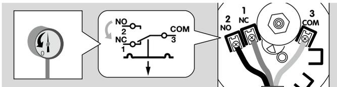
Bei Erreichen der Schaltpunkteinstellung schließt der Kontakt von COM 3 nach NC 1. Kontakt COM 3 nach NO 2 wird geöffnet. Beim Schließer entfällt der NC-Kontakt.
