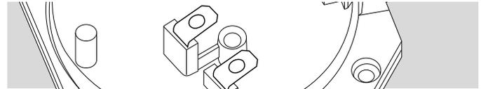
DL..E-1 für die Verdrahtung mit AMP-Flachsteckern
