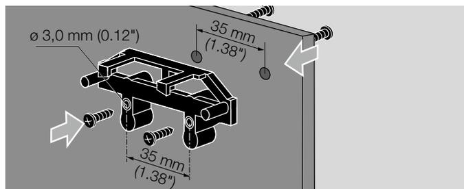
Für die druckdichte Befestigung wird der D-Clip von vorn oder von hinten an das Montageblech montiert. Der Druckwächter wird einfach auf den Clip gesteckt.
