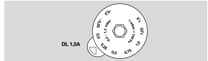
Der Anschluss des DL 1,5A ist abhängig vom positiven oder negativen Einstellbereich.
