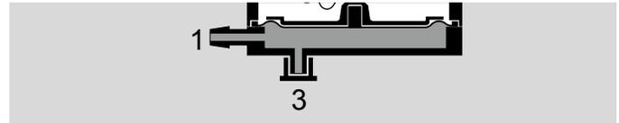
DL 5 – 50E-1P: An Anschluss **3** kann ein Messgerät angeschlossen oder der Kesseldruck abgefragt werden. Wenn der Anschluss **3** zur Druckmessung genutzt wird, muss die Verschlusskappe von **3** auf **1** umgesetzt werden.
