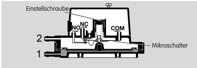
Der Luft-Druckwächter DL schaltet bei steigendem oder fallendem Druck. Ist der eingestellte Schaltpunkt erreicht, wird ein Mikroschalter im DL betätigt.
