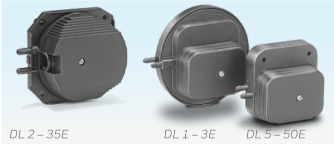
Mit seiner einfachen Ausstattung und seinem niedrigen Einstellbereich (20 bis 5000 Pa/0,08 bis 20 "WC) ist das Einsatzgebiet des DL..E z. B. die Gebläseüberwachung an Brennwertgeräten oder atmosphärischen Wandgeräten mit Abgasgebläse.
