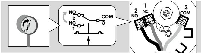
Bei Erreichen der Schaltpunkteinstellung schließt der Kontakt von COM 3 nach NO 2. Kontakt COM 3 nach NC 1 wird geöffnet. Beim Schließer entfällt der NC-Kontakt.
