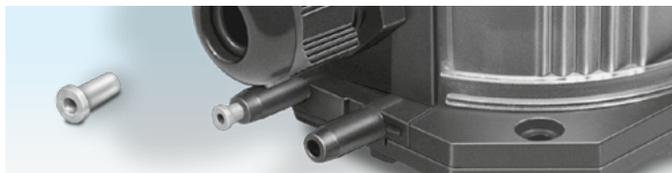
Die Dämpfungsdüse dämpft Druckschwingungen und Druckstöße ab. Ein kurzer Druckstoß in der Luftzuleitung entsteht z. B. beim Zünden eines Brenners. Dämpfungsdüse, siehe Seite 25 (Zubehör).
