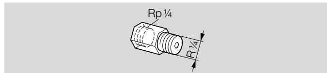
Bei starken Druckschwankungen empfehlen wir bei Gewindeanschluss Rp 1/4 eine Vordrossel (nicht buntmetallfrei) einzusetzen:
