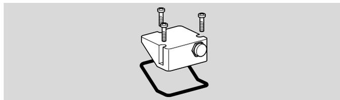
Um die Bildung von Schwitzwasser zu vermeiden, kann der Deckel mit Druckausgleichselement eingesetzt werden. Die Membrane in der Verschraubung dient zur Belüftung des Deckels, ohne dass Wasser eindringen kann.
