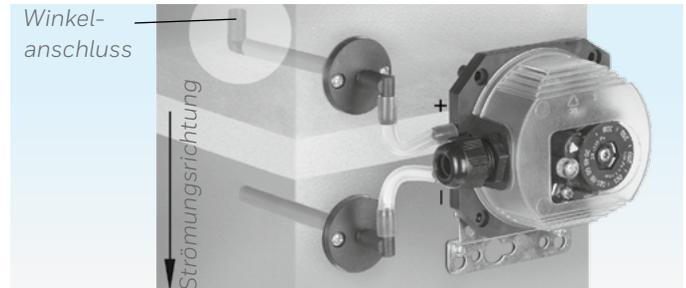
Der Winkelanschluss verstärkt das  $\Delta p$ -Signal, wenn dieses zu niedrig für den Einstellbereich des Druckwächters ist.
