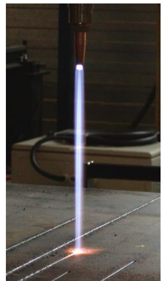
Starker Gasstrom des Schneidsauerstoffstrahl aus einer Koike Düse mit hoher Strahldivergenz: Aufnahme während eines Leistungstests im hauseigenen Koike Testlabor. Düse 275mm oberhalb der Platte, Düse 106-D7#0.
