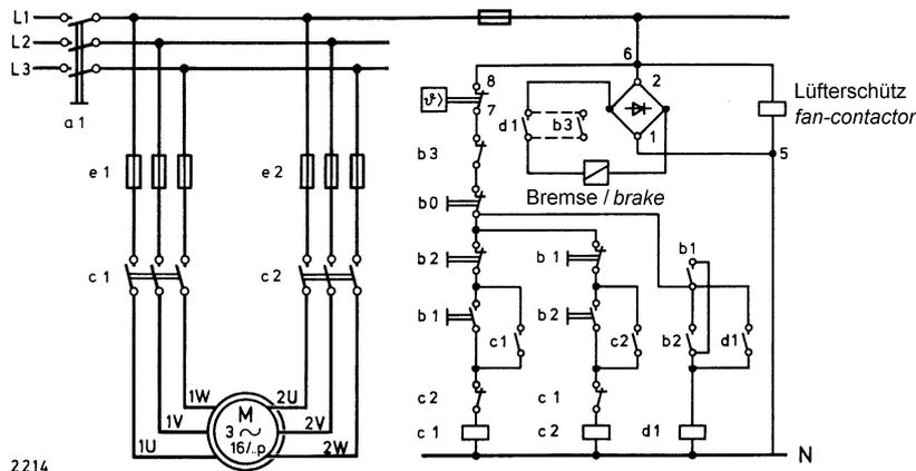
Wird der Hauptschalter a1 eingeschaltet, bekommen Lüfterschütz und Brückengleichrichter Spannung, die Fremdkühlung ist nun ständig wirksam.
