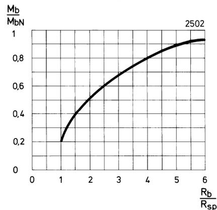
Bremsmoment  $M_b$  zu Nennbremsmoment  $M_{bN}$  in Abhängigkeit vom Verhältnis Widerstand  $R_b$  zum Bremspulenwiderstand  $R_{sp}$
