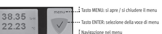
**Nota:** è possibile evitare un accesso non autorizzato al menu bloccando l'opzione "Display Menu" (se si utilizza il software HW4 > Manager strumenti > Display).
