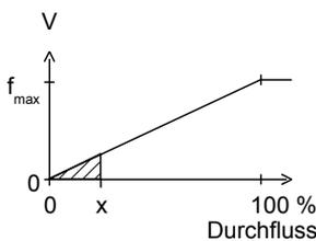
f<sub>max</sub> wählbar im Bereich bis zu 2000 Hz
