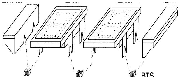
Ziffernanzeigen mit Abschlusswinkelpaar und Befestigungsteile.
