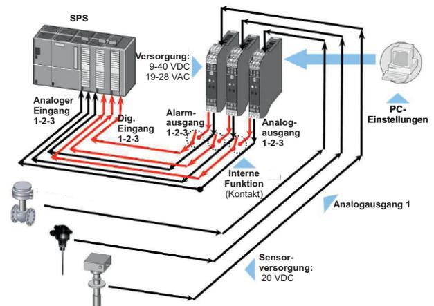
Vorteil: Nur ein analoger Eingang an der SPS ist erforderlich, um das analoge Ausgangssignal von mehreren WZ109REG2 zu erfassen.
