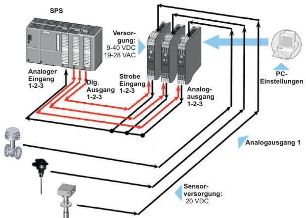
Vorteil: Der WZ109REG2 kann einen Alarmwert überwachen und über ein Relais ausgeben. Der Alarmwert kann von 0 bis 100% des universellen Eingangswerts eingestellt werden..
