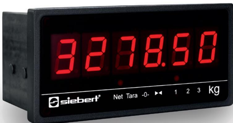
Die kompakten Geräte im 96 x 48 mm grossen Einbaugehäuse sind spezielle Ausführungen der Serie S102 und kompatibel zu den Wägerechnerfabrikaten Siemens Siwarex und Phoenix Contact.
