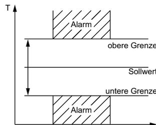
Sollte der Istwert außerhalb der eingestellten Temperaturgrenzen liegen, also oberhalb des oberen Grenzwertes oder unterhalb des unteren Grenzwertes, so ist der Alarmkontakt aktiv.
