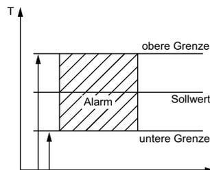
Umgekehrtes Schaltverhalten wie beim Grenzwertalarm. Alarmkontakt ist angezogen, wenn der Istwert innerhalb der eingestellten Grenzwerte liegt.
