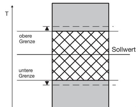
Bild 8: Bandalarm, Alarmkontakt invers
