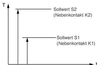
Die Kontakte K1 und K2 sind unabhängig voneinander einstellbar. (Betrieb mit Sollwert 2). Kontakt K1 arbeitet auf Basis von Sollwert 1, und K2 auf der Basis von dem als Grenzwert einstellbaren Sollwert 2.
