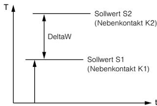
Die Kontakte K1 und K2 sind über eine Schaltdifferenz Delta W miteinander verknüpft (Betrieb mit Delta W). Diese Differenz kann positive oder negative Werte annehmen. Es kann also ein voreilender oder nacheilender Nebenkontakt realisiert werden.
