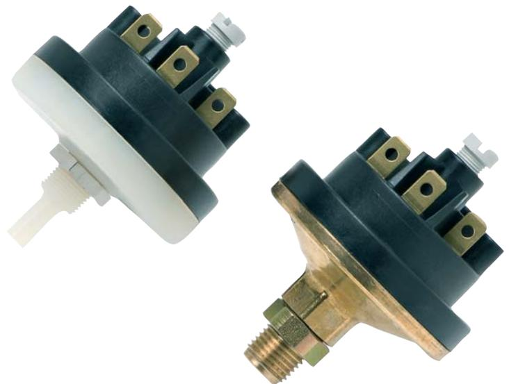
Die Druckschalter der Typenreihe 620/625 mit 13 Druckbereichs-abstufungen eignen sich für Flüssigkeiten und Gase. Druckanschlüsse sind erhältlich in ABS, PA 66, Messing oder Aluminium, die Membrane in NBR-Basis, FPM, EPDM oder Silikon. Durch fein abgestimmte Messbereiche und hohe Langzeitstabilität sehr genau. Robuste Bauart und daher speziell geeignet für den allgemeinen Apparatebau, in der Verfahrenstechnik und der Food-Automation.
