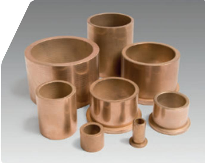
Das gesinterte Gleitlager ist eines der ältesten Produkte der Pulvermetallurgie. Sintergleitlager haben sich seit Jahrzehnten in allen Bereichen der Technik bewährt. Ihre guten Lagereigenschaften werden entscheidend durch die hohe Fertigungsgenauigkeit und die Porosität des Sinterwerkstoffes bestimmt. Diese beiden Merkmale sind auch für die Funktion eines Sintergleitlagers als selbstschmierendes Gleitlager von besonderer Bedeutung.
