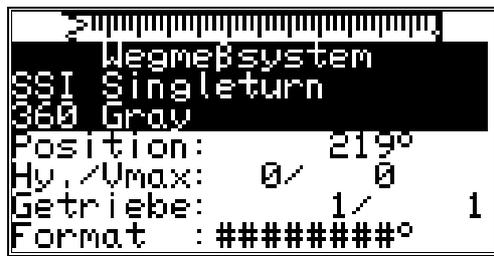
Hier können Sie das Wegmeßsystem, die Auflösung, das elektronische Getriebe, die Istwert - Hysterese, die Drehrichtung und das Darstellungsformat des Istwertes einstellen, sowie ein Sonder-Wegmeßsystem konfigurieren. Zusätzlich wird im Menüpunkt "**Position:**" der aktuelle Istwert des CamCons angezeigt. Sehen Sie hierzu auch Kapitel "4.2. Das Wegmeßsystem" auf Seite 20.
