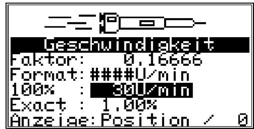
Es dient dazu, das Gerät optimal an die Drehzahl ihrer Maschine anzupassen. So können Sie hier z.B. die angezeigte Geschwindigkeit durch Faktoren verändern oder durch Dämpfung beruhigen.
