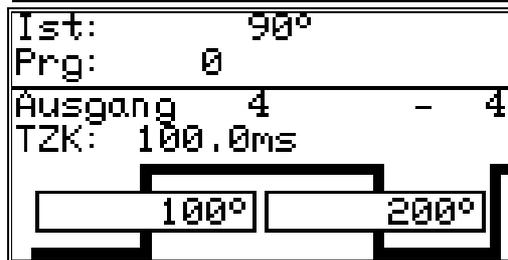
3. Mit der Taste Ausgang 4 anwählen oder Taste betätigen, "4" eingeben und Taste betätigen.
