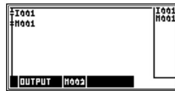
Merker 2 wird für einen Zyklus eingeschaltet, wenn das Signal am Eingang 1 von 0 auf 1 wechselt.
