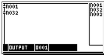
Ausgang 1 des CamCon wird freigegeben, wenn der Drehrichtungsausgang 32 **eingeschaltet** ist. Dies ist dann der Fall, wenn die Drehrichtung **positiv** ist.
