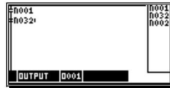
Ausgang 1 des CamCon wird freigegeben, wenn der Drehrichtungsausgang 32 **ausgeschaltet** ist. Dies ist dann der Fall, wenn die Drehrichtung **negativ** ist.
