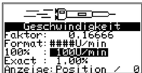
Der Wert legt den Endpunkt der Balkenanzeige für die Geschwindigkeit fest, die in der Standardanzeige dargestellt wird. Seine Länge gibt die Momentandrehzahl relativ zur eingegebenen Referenzdrehzahl in Prozent an. Darüber hinaus wird hier auch die Geschwindigkeitsschwelle eingestellt, bei der die Standardanzeige von Position - auf Geschwindigkeitsanzeige umschaltet. Diese Schwelle liegt immer bei 5% des hier eingestellten Wertes, also für 1000U/min bei 50U/min.
