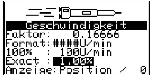
**Hinweis:** Der **"Exact"** Wert wirkt sich auch auf den Geschwindigkeitswert aus, der über die Ausgänge oder über ein CP16 bzw. über ein CamCon DC115 einer SPS zur Verfügung gestellt wird.
