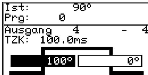
Werden nun die Tasten **◀** oder **▶** betätigt, so werden alle Nocken dieses Ausgangs um ein Inkrement verschoben. Die Nocken werden in diesem Fall direkt in den Speicher übernommen ohne vorheriges Betätigen der Taste **CR**. Den Vorgang des Verschiebens beenden Sie durch Betätigen der Tasten **CR** oder **ESC**.
