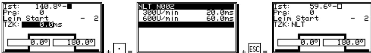
Hier wird durch Betätigen der Taste  $\square$  ein Geschwindigkeitswert bzw. Stützpunkt und der zugeordnete gewünschte Totzeitwert eingegeben bzw. eingefügt. Nach der Eingabe von minimal zwei Stützpunkten wird der Totzeitwert zwischen den einzelnen Stützpunkten linear interpoliert. Durch die Eingabe von mehreren Geschwindigkeitspunkten und deren Totzeitwerte, ist es nun möglich eine Kurve zu definieren, die dem Verhalten der Totzeit an der Maschine entspricht.
