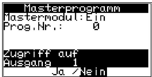
Hierbei können Sie durch die Tasten und den Zugriff des Ausgangs auf das Masterprogramm Ein (JA) - und Ausschalten (Nein). Durch die Tasten und wird die gewünschte Ausgangsnummer bzw. Nockenspur ausgewählt.
