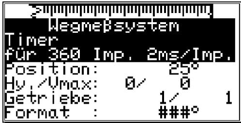
1. Wählen Sie im Konfigurationsmenü den Punkt "Wegmeßsystem". Es erscheint das folgende Menü: 2. Mit den  und  Tasten das Sonder - Wegmeßsystem auswählen.
