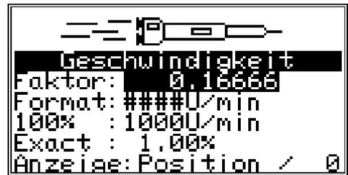
**Beispiel 1:** Ein Dreh - Winkelcodierer mit 512 Schritten liefert 512 Inkremente pro Minute, d.h. der Antrieb läuft mit 1 U/min. CamCon mißt daher  $512/60 = 8,533$  Inkremente pro Sekunde. Um nun eine Anzeige in U/min zu erhalten, müssen Sie entsprechend einen Faktor von  $1 / 8,533 = 0,1172$  eingeben.
