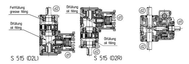
Alle Wälzlager in Getrieben mit Ölfüllung, die aufgrund ihrer Einbaulage eine Mangelschmierung zu erwarten haben, sind in abgedeckter Form auszuwählen.
