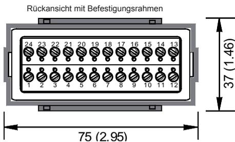
Befestigungsrahmen von hinten aufschieben und einrasten lassen.
